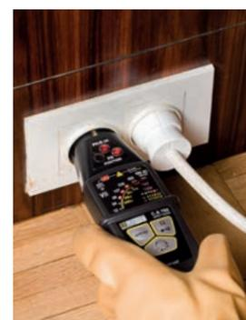
L'adaptateur C.A. 753, par sa conception, permet l'usage de toutes pointes de mesure ( $\varnothing 2$ ,  $\varnothing 4$ , IP2X, ...). Il évite tout risque de non-détection de tension en garantissant un bon contact électrique et mécanique entre celles-ci et la prise 2P+T.
