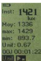
Détermination de l'**uniformité** d'éclairement d'un local avec représentation graphique des postes de travail et luminaires
