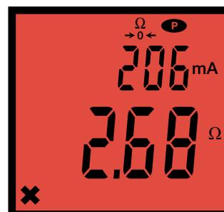
Mesure de continuité à 200 mA avec mesure  $> 2 \Omega$
