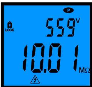
Mesure d'isolement, avec affichage simultané de l'isolement et de la tension réelle de test
