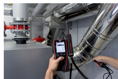
Mesure d'hygrométrie et de vitesse
