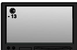
Un **symbole d'aiguille** en haut à gauche indique en permanence le sens de gravité, c'est-à-dire la direction vers le sol. L'utilisateur peut ainsi reconnaître où est le haut et le bas du tuyau.
