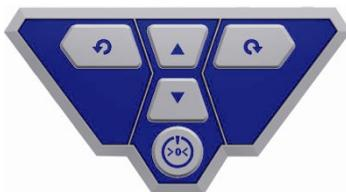
Panneau de commande avec bouton MARCHE/ARRET et boutons de commande pour la tête de caméra pivotante et orientable.
