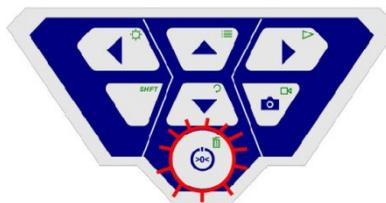
Fig. 18: Panneau de commande Wöhler VIS 250/350 -Bouton MARCHÉ/ARRÊT avec contour clignotante.
