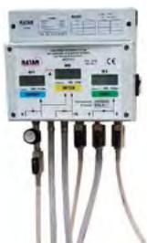
**Appareil de contrôle des disconnecteurs et des dispositifs de robinetterie installés sur les réseaux d'eau potable**
