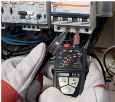
Simple et rapide, la rotation de phase est pertinente y compris pour des circuits isolés par un transformateur d'isolement.
