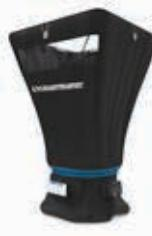
Effectue efficacement des mesures du volume d'air directement sur une bouche d'aération
