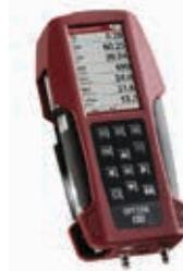
Analyseur multigaz de combustion
